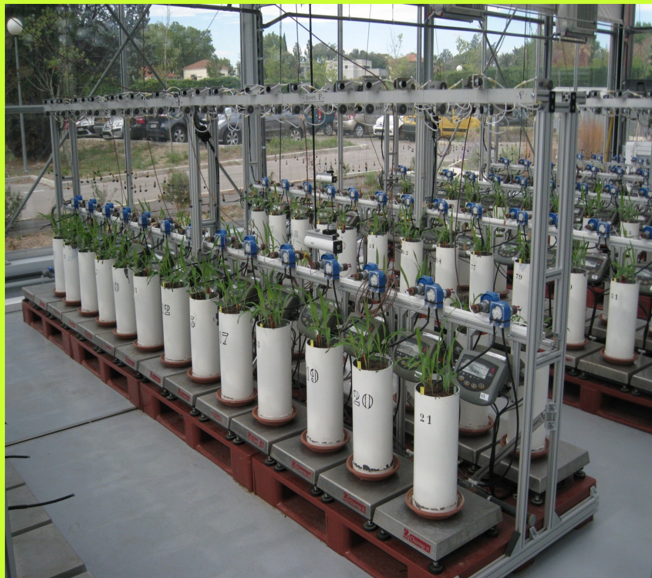
Exemple de périphériques en acquisition automatique (balances)
